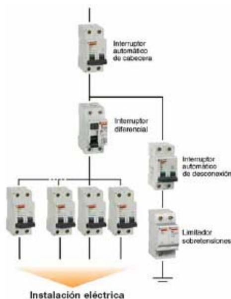
Nota: en función del fabricante, pueden existir protectores con magnetotérmico integrados
