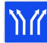
S-63 Bifurcación en calzada de cuatro carriles
