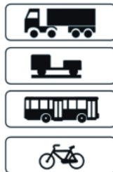
S-880 Aplicación de señalización a determinados vehículos. Panel complementario de una señal vertical
