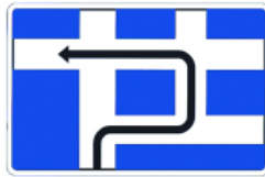
S-250 Preseñalización de itinerario
