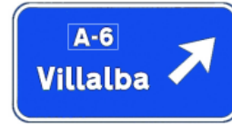
S-222 Preseñalización de direcciones hacia una autopista o autovía
