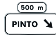
S-230 Preseñalización con señales sobre la calzada en carretera convencional hacia carretera convencional
