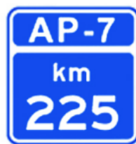
S-570a Hito kilométrico en autopista de peaje
