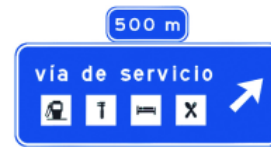
S-266a Preseñalización en autopista o autovía de una vía de servicio con salida exclusiva
