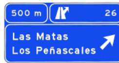
S-225 Preseñalización de direcciones en una autopista o una autovía hacia cualquier carretera
